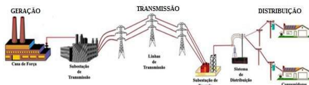
Figura 1: Exemplo de Geração, Transmissão, Interligação e Distribuição em um Sistema Elétrico de Potência[1].
