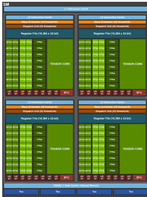
Figura 3.2: SM da arquitetura Ampere da NVIDIA - [Zone 2019]
