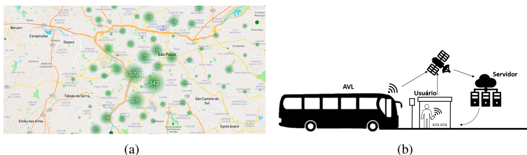
Figura 1. (a) Mapa de distribuição de localizações das contribuições coletivas, (b) Coleta de dados de posicionamento dos ônibus.
